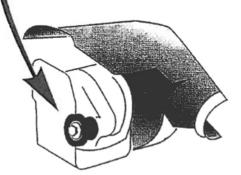
IMPORTANT: En cas d'échange de la poulie réducteur, il est nécessaire de remplacer obligatoirement la courroie. d'entraînement du tambour
